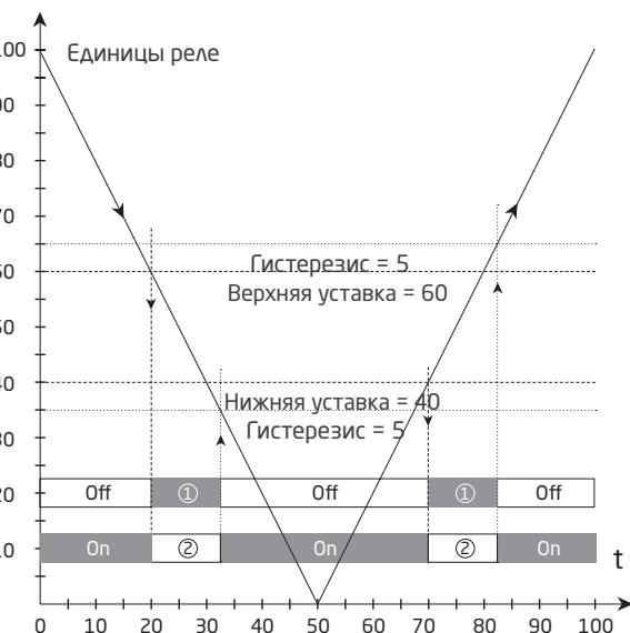
Функция реле: окно (для снижающегося сигнала)
